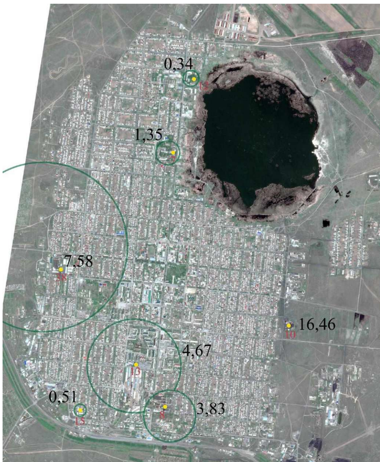
Рис. 11. Распределение котельных городской зоны теплоснабжения по действительной нагрузке
