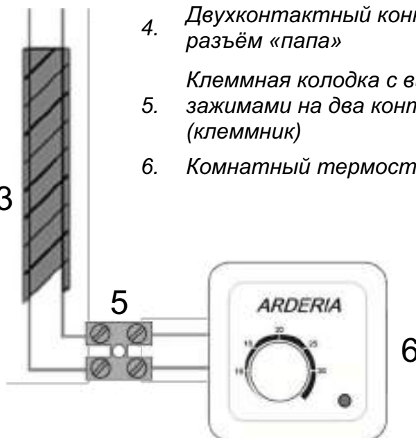
Рис. 49 Принципиальная схема подключения комнатного термостата непосредственно к электропроводке (двум проводам в электроизоляционной трубке) присоединённой к плате управления котлом через разъём CN7.
