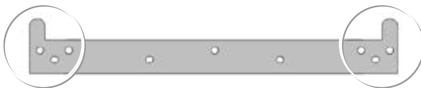
Рис. 15 Монтажная планка (кронштейн крепления котла на стене).
